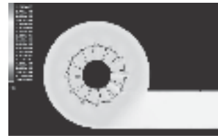
Hình 4. Đường phân bố áp suất trong Turbine.
